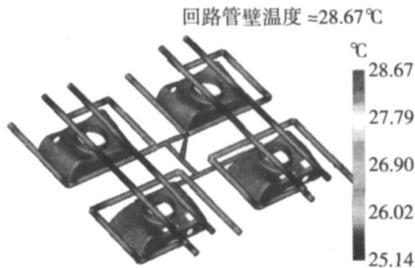
图 7 管道表面金属温度分析结果
